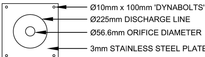
ORIFICE PLATE DETAIL N.T.S.
