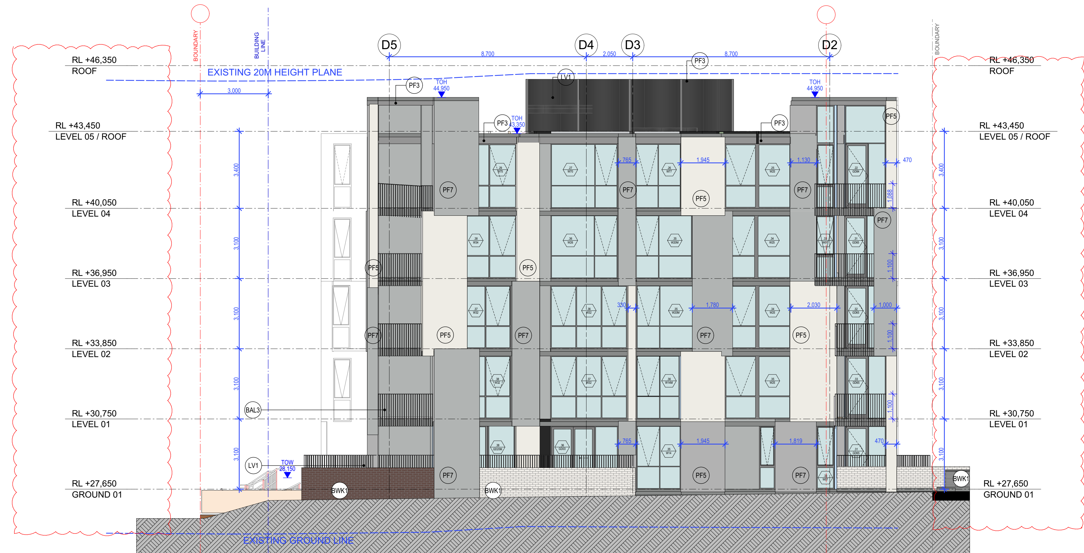
2 South D2 ELEVATION 1:100
