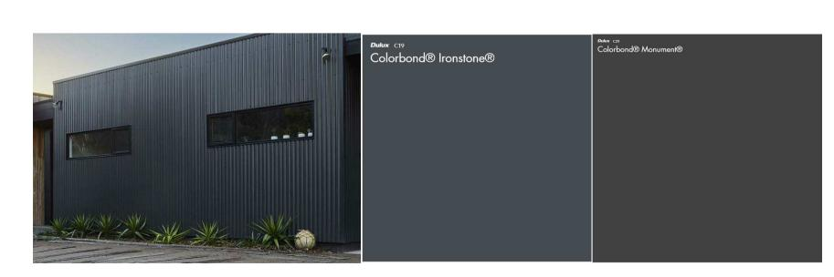
WF.01: CUSTOM ORB CLADDING -COLOR IN DULUX COLORBOND IRONSTONE (C19) OR SIMILAR; FLASHING, FASCIAS, GUTTERS & DETAILINGS IN DULUX COLORBOND MONUMENT (C29)
