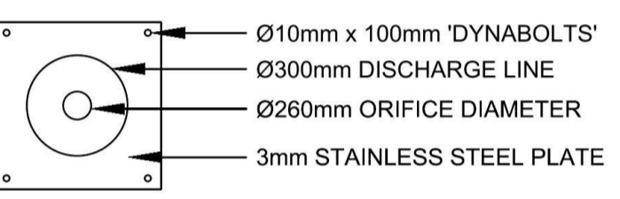
ORIFICE PLATE DETAIL N.T.S.
