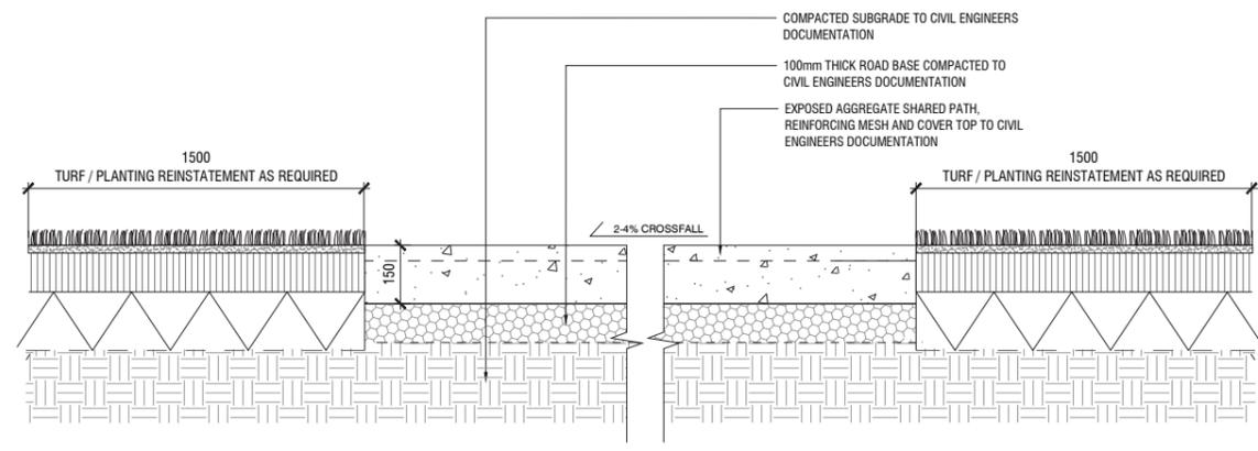
01 INSITU CONCRETE FOOTPATH TYPICAL LAYOUT PLAN
